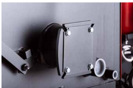
Подключение горелки на биотопливе
